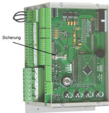
Gehäuse mit beiden Elektronik-Platinen
